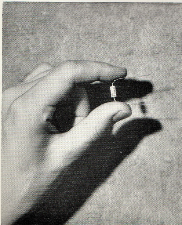
Fig. 4.—Germanium crystal rectifier.
